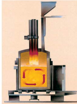
Pfannenmetallurgie Métallurgie du four à poêle
